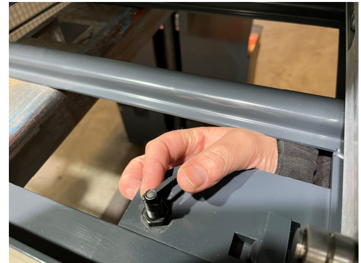
Fuß / Rolle einsetzen, um 90° drehen und Rastriegel wieder schließen.
