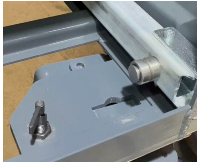
Fuß / Rolle um 90° drehen und nach unten entnehmen
